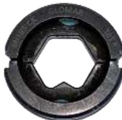
Une pince à sertir hydraulique et des jeux de matrices hexagonales doivent être utilisés pour obtenir de bons raccordement sertis. Le choix du bon insert de presse est important pour obtenir un résultat fiable. Étant donné que les diamètres des câbles varient considérablement, le tableau suivant sert de guide pour la sélection appropriée des inserts. Des essais de traction avec le câble doivent être effectués.
